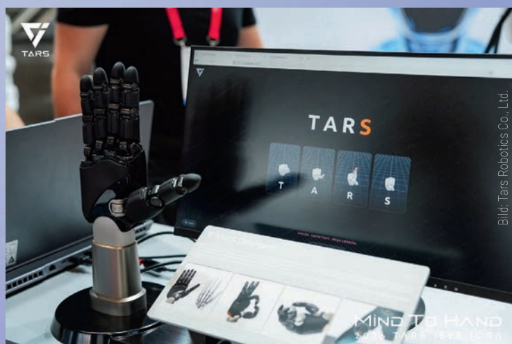
Die DexHand von Tars Robotics arbeitet mit 21 Freiheitsgraden, was weitgehend der natürlichen kinematischen Struktur der menschlichen Hand entspricht.
