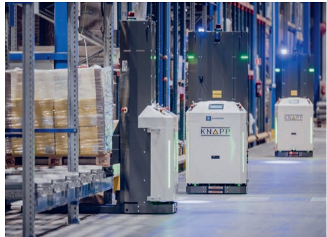
Die Transportaufträge der AMR werden über KiSoft Fleet Control System (KiSoft FCS) koordiniert.
