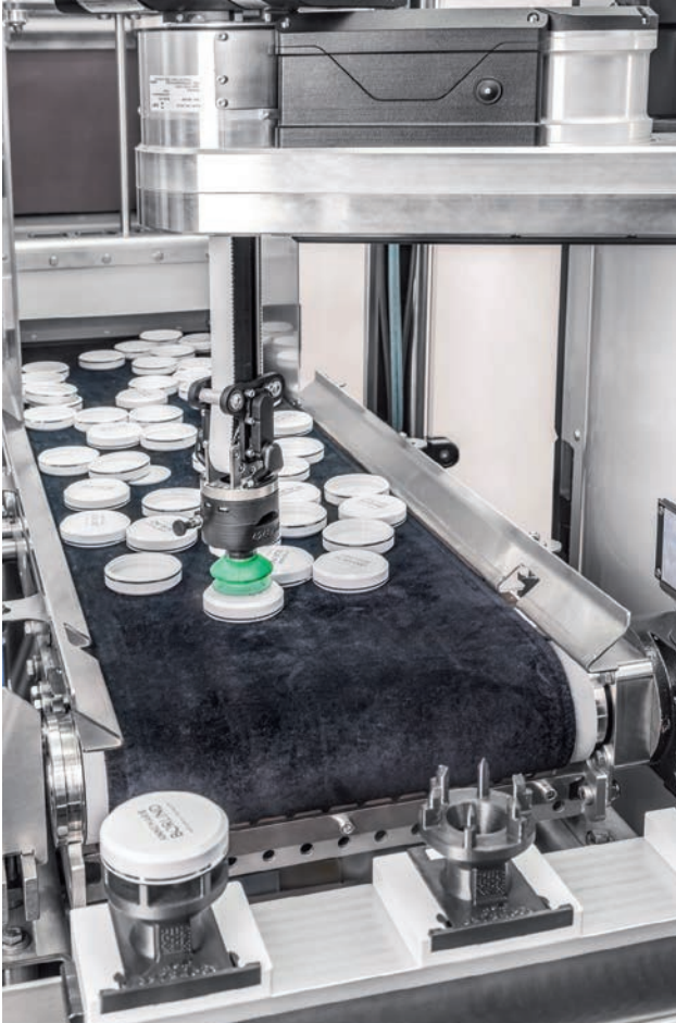
Mithilfe intelligenter Bildverarbeitung erkennt der kognitive TOG-Cobot Produkte und kann diese auch aus der Unordnung schnell und effizient auf Ketten, Bänder oder in Behältern platzieren.
