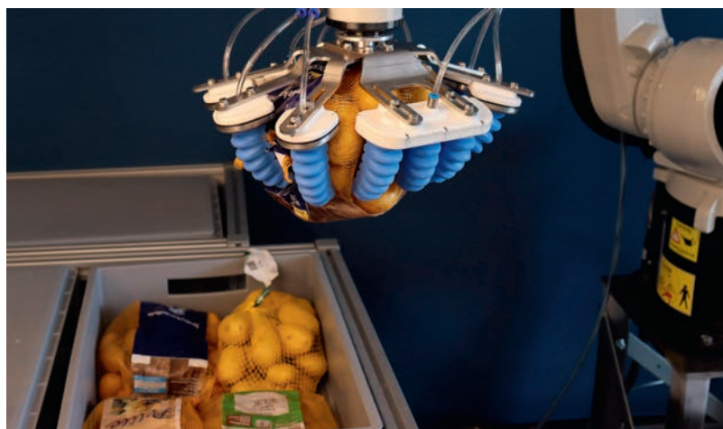
Die neue Fingergeometrie ermöglicht präzises Greifen und Platzieren auch bei hoher Belastung und engem Bauraum.
