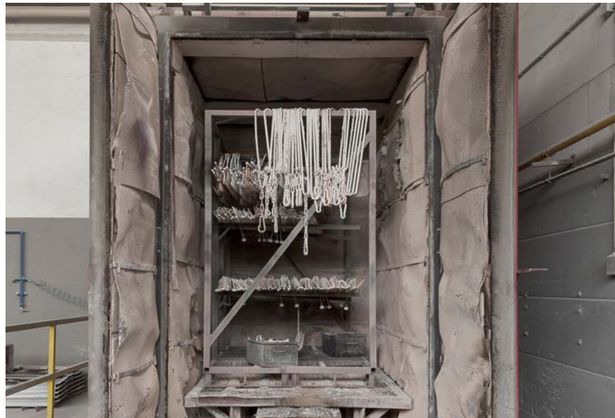
Im Pyrolyse-Ofen haben hartnäckige Beschichtungen keine Chance.
