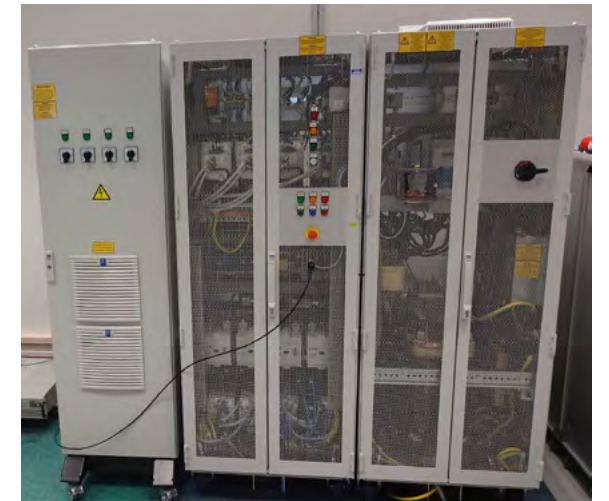
Drehstrom-Asynchronmotor-Emulator zur Frequenzumrichter-Last-Prüfung
