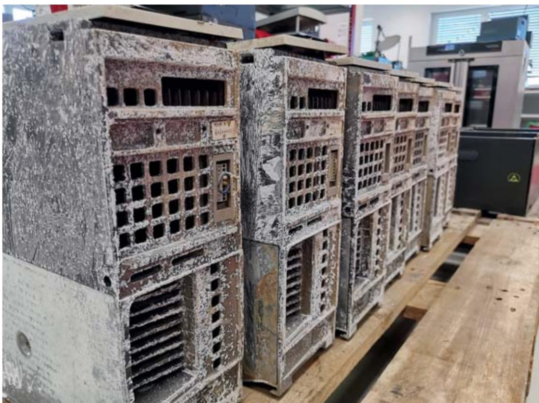
Palettenweise werden verschmutzte und beschädigte Elektronik-Bauteile aus den Überschwemmungsgebieten im Westen Deutschlands wie diese Umrichter bei Eichler in Pürgen angeliefert – dort werden sie gereinigt und repariert. Bilder: Stefan Weinzierl
